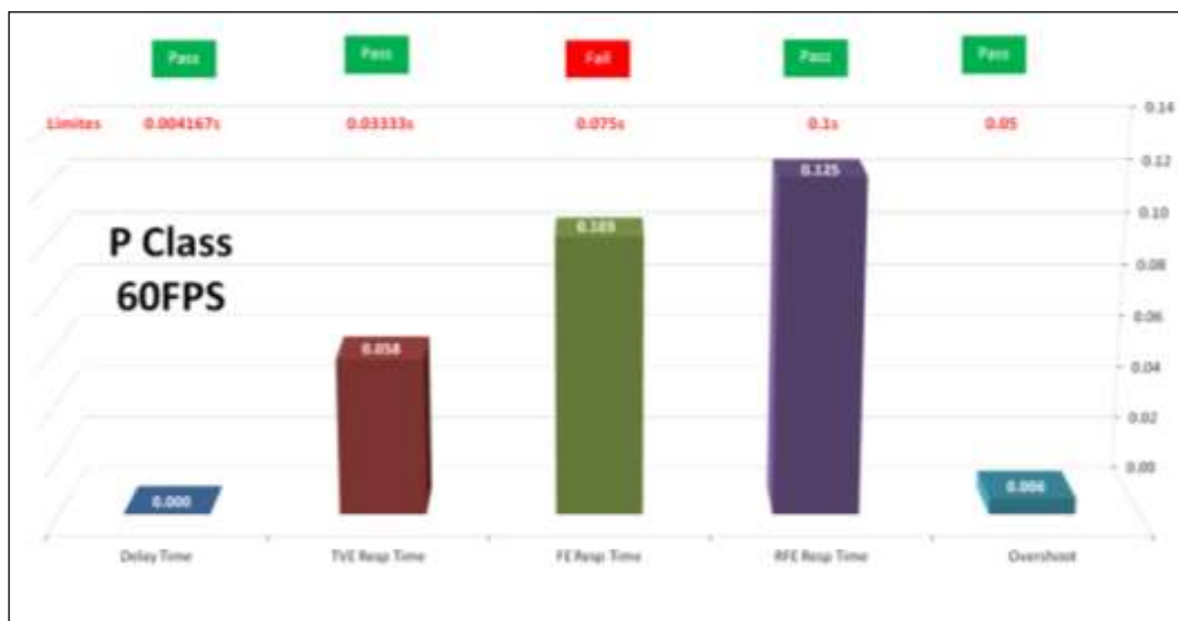
Figura 6 - Resultado de teste de degrau de fase.
