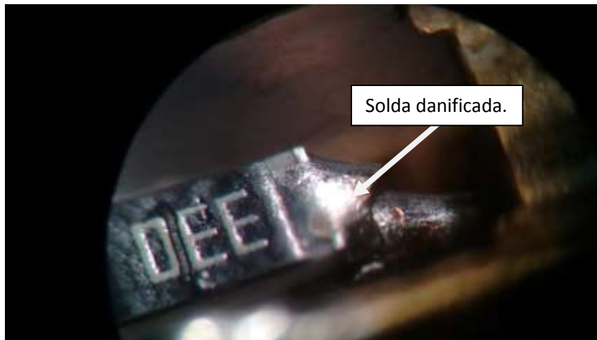
Figura 7 - Fotografia do resistor danificado.
